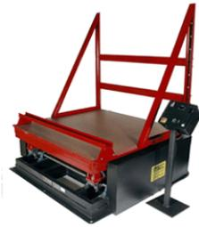
*Im Labor werden Vibrationen mit verschiedenen Frequenzen auf einen Vibrationstisch simuliert*
