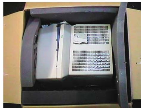
Hier **muss** eine eigens dafür konstruierte und getestete Verpackung eingesetzt werden. Beispiele sind Halbschalen oder Tragerahmen aus EPS, PE-/ PU-/ PP-Schaum oder Wellpappe-Romwell (mehrlagige Wellpappolster) Kombinationen, welche zuvor entsprechend der DIN EN bzw. ISTA geprüft wurden.
